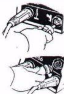
Zasuňte elektronickou řídící kabelaci svařovací pistole
