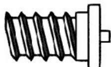
Kondensator - Schweißbolzen mit Grobgewinde Werkstoff: St 37-3 verk. Abmessungsbereich: von Ø 5 x 9 bis Ø 5 x 25
