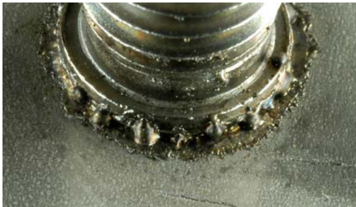
Pohled na svar a makrostrukturální řez nerezovým svorníkem M 8 po přivaření na legovanou ocel. Přivařeno hrotovým zážehem kontaktním způsobem, použit fil ze saponátové vody.
