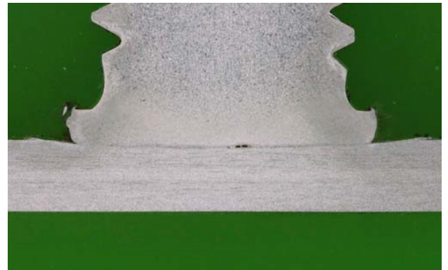
Pohled na svar a makrostrukturální řez nerezovým svorníkem M 8 po přivaření na legovanou ocel. Přivařeno hrotovým zážehem kontaktním způsobem, použit fil ze saponátové vody.
